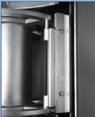
Bewegliches Blatt mit PTFE Kante. Mobile blade with PTFE bar (B-Type).
